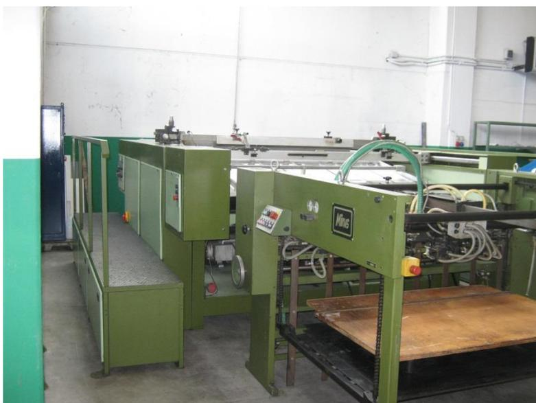
Macchina automatica stampa a cilindro marca Siasprint mod. Progress, completa di fotocellule sia all'interno del cilindro che nei registri laterali, tavola basculante in uscita, velocità di stampa regolabile fino a 1500 fogli/ora,
